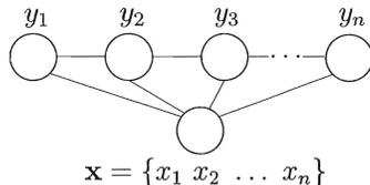
图 14.6 链式条件随机场的图结构
