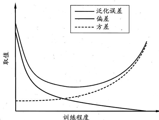
图 2.9 泛化误差与偏差、方差的关系示意图
