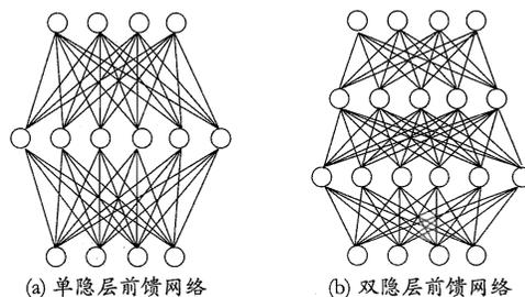
图 5.6 多层前馈神经网络结构示意图
