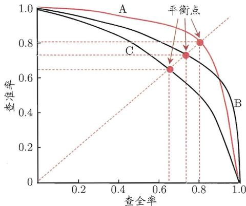
图 2.3 P-R曲线与平衡点示意图
