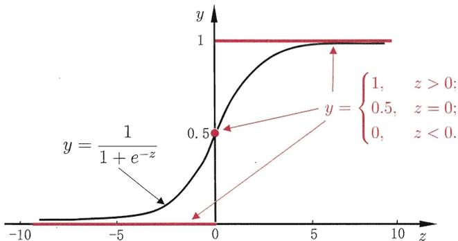
图 3.2 单位阶跃函数与对数几率函数
