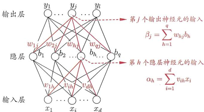
图 5.7 BP 网络及算法中的变量符号
