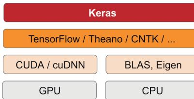
图 3-3 深度学习的软件栈和硬件栈
